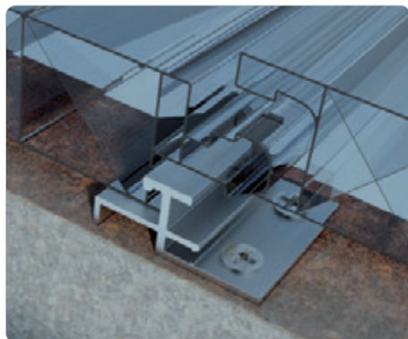
INCASTRO PIASTRINA Ancoraggio alle strutture esistenti, mediante inserimento piastre in AL
