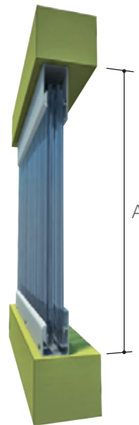
SENZA GOCCIOLATOIO LP = A - 40 \text{ mm} A = \text{misura luce}
