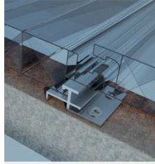
dettaglio posizionamento piastrina 4052 per il fissaggio dei pannelli
