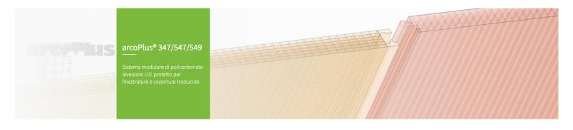
arcoPlus ® 547 e arcoPlus ® 549 sono dei sistemi modulari composti da pannelli di policarbonato alveolare coestruso a 7 pareti (arcoPlus®547) e 9 pareti (arcoPlus ® 549), dello spessore di 40mm, profili in alluminio, accessori e finestre apribili, progettati per renderne semplice e versatile l?utilizzo. Tutti i sistemi indicati possono essere utilizzati per coperture con pendenza superiore al 7%.
